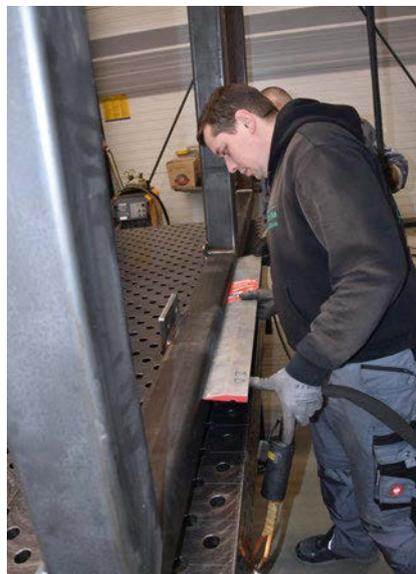
▲ Bild 10. Auch dieses große Bauteil wurde durch Tiefeninduktion ohne Dehnungsbehinderung werkstoffschonend gerichtet.
